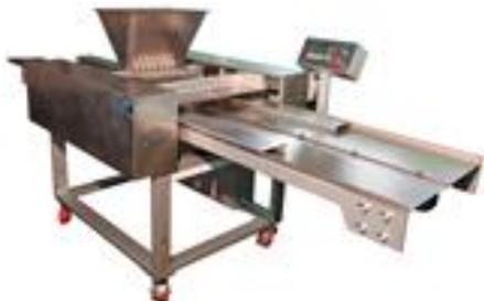
на силиконовые формовочные коврики. Принцип работы машины основан на поршневой группе дюз отливки. Движение механизмов организовано на базе пневматической системы. Дозирование при этом определяется ходом поршня. Система управления на базе программируемого контроллера позволяет моментально настраивать режимы работы, упрощая переход к выпуску различных видов продукции.
