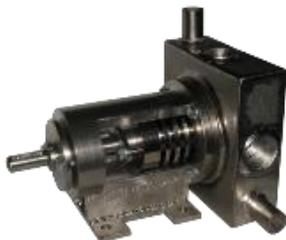
Шестеренчатый насос НШ-02 с внутренним зацеплением зуба предназначен для перекачивания высокотемпературных жидкостей средней и высокой вязкости. Используется на кондитерском производстве для перекачки сахарного сиропа, мармеладной массы и т. д.
